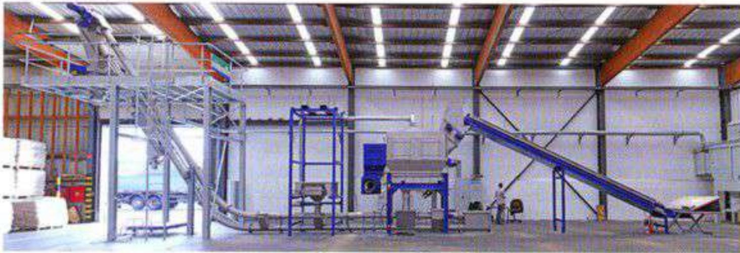
Ein schneller Verladeprozess bei gleichzeitig flexibler Gebindeauswahl ist ein wichtiger Faktor im betrieblichen Logistikmanagement. Die Anlage für Produktumschlag der R+B Technik kombiniert diese beiden Anforderungen. Produktberührte Teile sind in Edelstahl ausgeführt und eine ex-geschützte Ausführung für explosionsgefährdete Pro-
